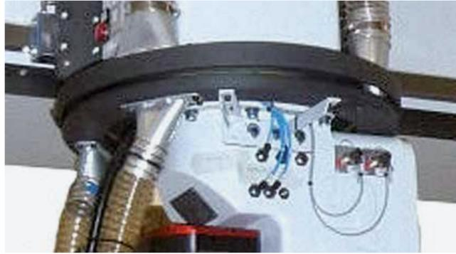
Coletor rotativo para sistema de aspiração
