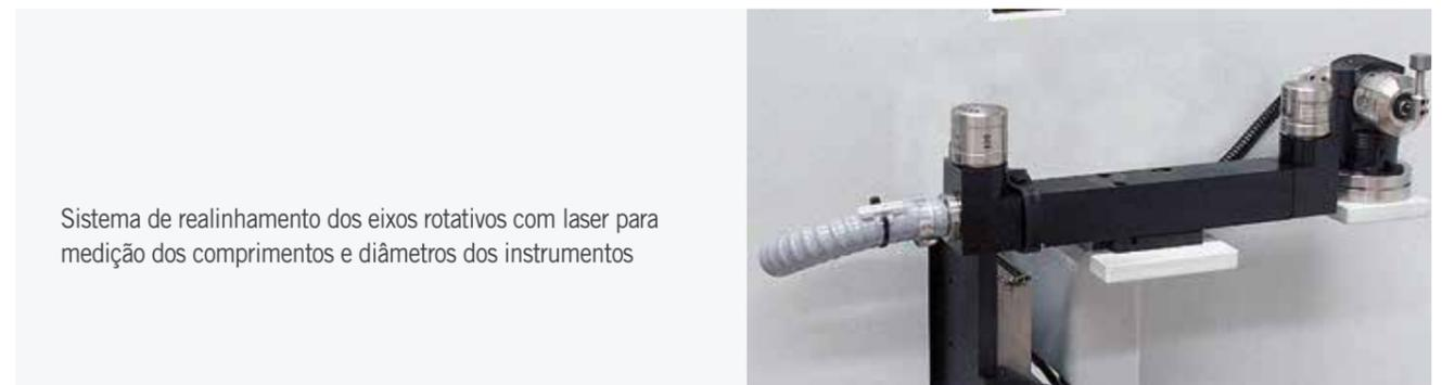
Sistema de realinhamento dos eixos rotativos com laser para medição dos comprimentos e diâmetros dos instrumentos
