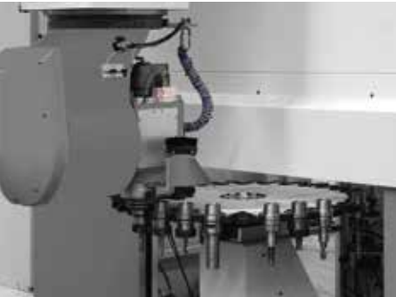
Innen- und Außenansicht Magazin für Werkzeugwechsel mit 30 Stationen
