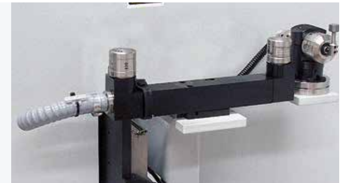
Neuausrichtung der Drehachsen mit Laser für die Messung von Werkzeuglänge und -durchmesser.
