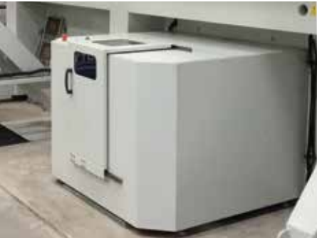
Innen- und Außenansicht Magazin für Werkzeugwechsel mit 30 Stationen
