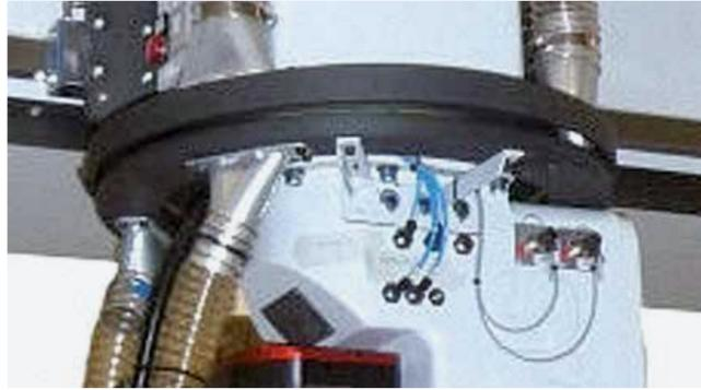
Coletor rotativo para sistema de aspiração
