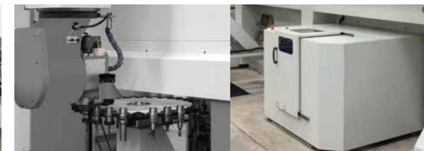
Visão interna e externa do depósito de troca de ferramentas com 30 divisões.
