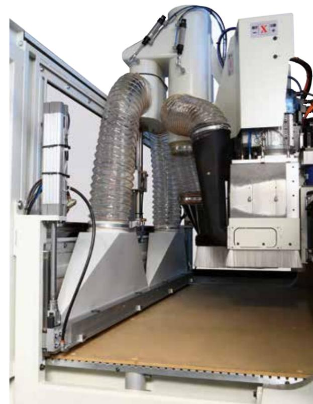
**Null Staub** und größtmögliche Entfernung von Kunststoffspänen mit dem oberen Absaugsystem zur Reinigung des Arbeitstisches.
