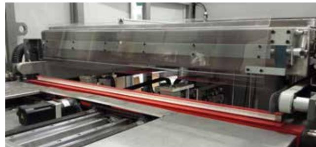
**Sistema di pulizia lastra con aria ionizzata:** rimuove le cariche elettrostatiche da ogni lastra e dal pallet installato nella zona di carico. Il massimo in termini di qualità di termoformatura e sicurezza.
