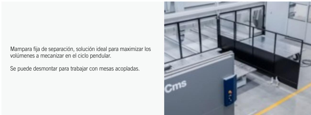
Mampara fija de separación, solución ideal para maximizar los volúmenes a mecanizar en el ciclo pendular.
