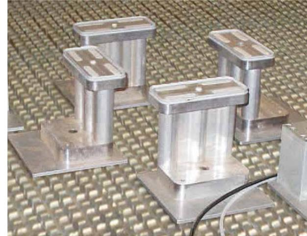
Ventosas y topes de referencia para la máxima flexibilidad de sujeción de la pieza.
