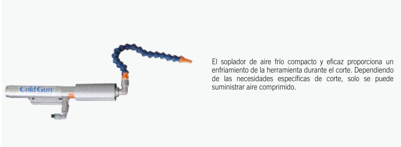
El soplador de aire frío compacto y eficaz proporciona un enfriamiento de la herramienta durante el corte. Dependiendo de las necesidades específicas de corte, solo se puede suministrar aire comprimido.
