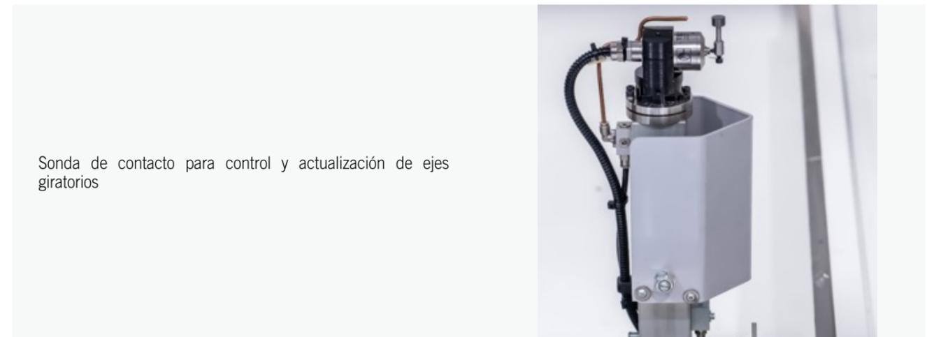
Sonda de contacto para control y actualización de ejes giratorios
