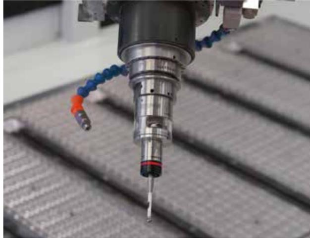
Dispositivo de sondeo montado en el cargador de herramientas con transmisión de señal por radio.
