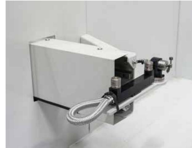
Sistema de realinhamento dos eixos giratórios com laser para a medição de comprimento e diâmetro dos instrumentos.
