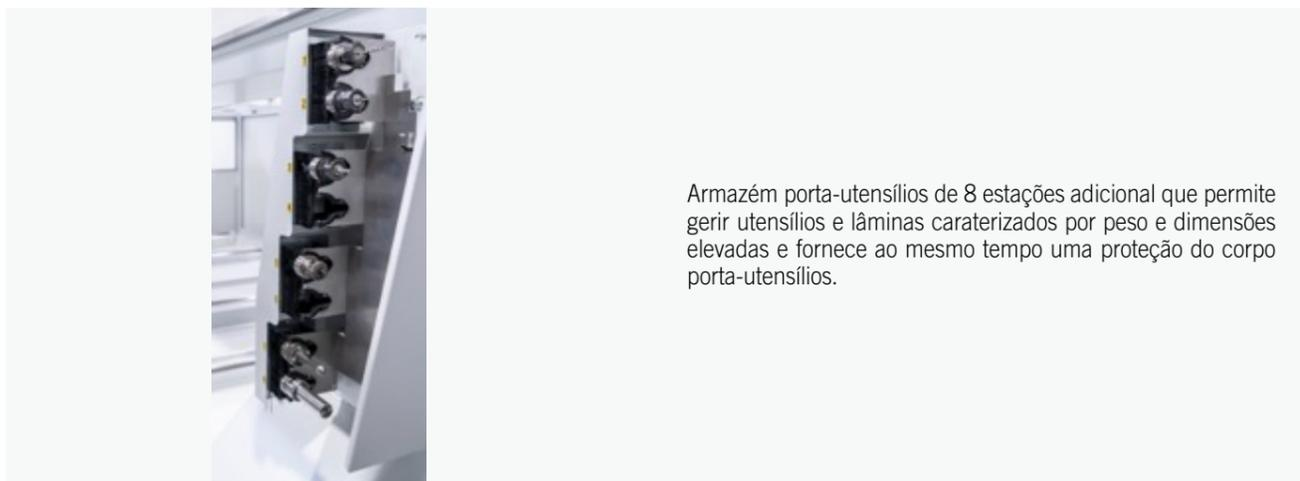
Armazém porta-utensílios de 8 estações adicional que permite gerir utensílios e lâminas caracterizados por peso e dimensões elevadas e fornece ao mesmo tempo uma proteção do corpo porta-utensílios.
