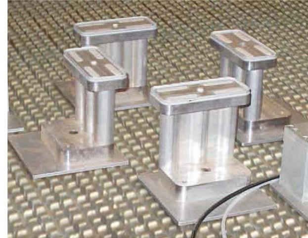
Ventosas e freios de referência para a máxima flexibilidade de bloqueio da peça.
