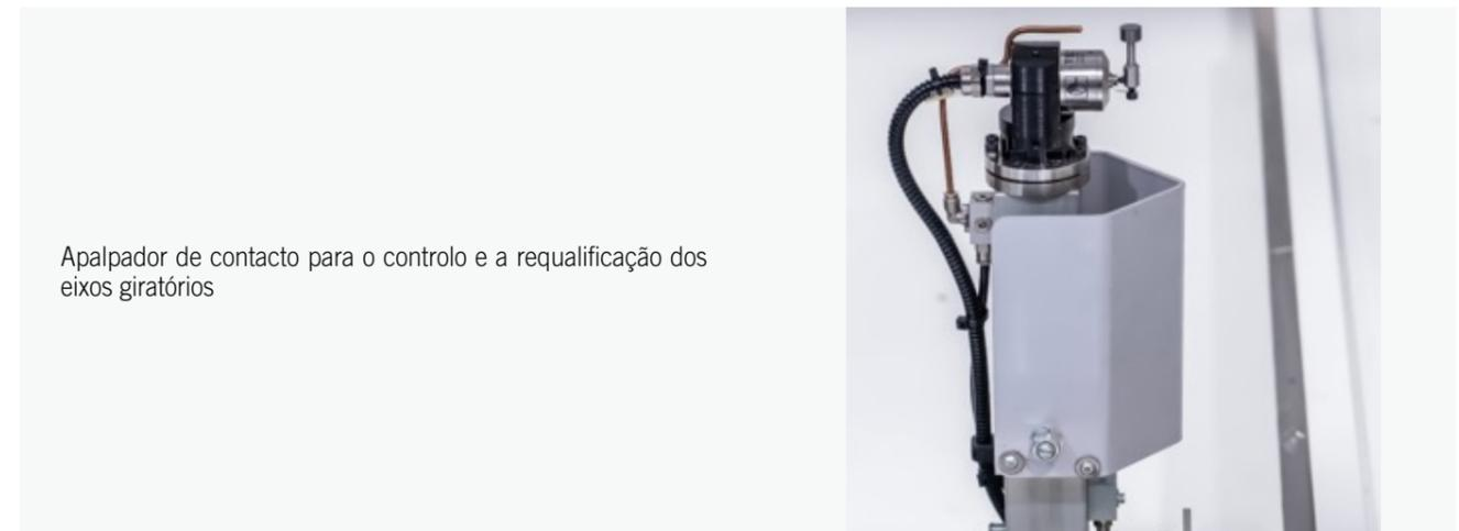
Apalpador de contacto para o controlo e a requalificação dos eixos giratórios
