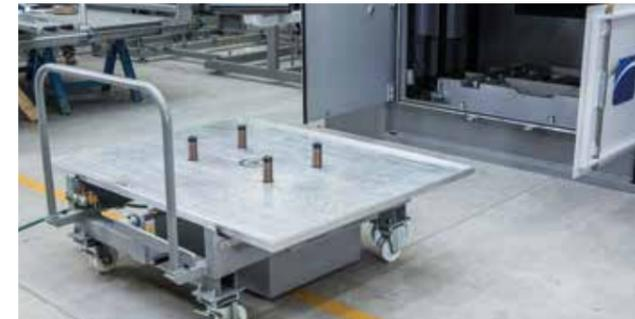
Formwerkzeugwagen mit integriertem System zur Anhebung der Formwerkzeuge (nur für bestimmte Größen erhältlich)
