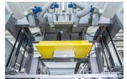
Obere Formwerkzeugaufnahme (für die Druckformung)
