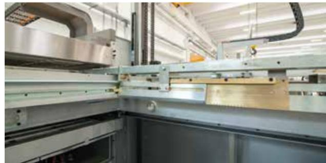
Sistema centratura lastra automatico con rilevamento doppia lastra
