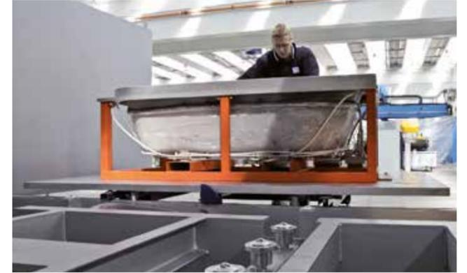
Spannrahmen mit automatischer Einstellung
