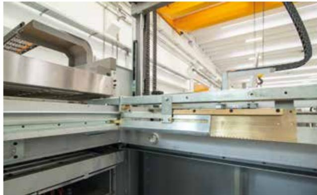
Formwerkzeugwagen mit integriertem System zur Anhebung der Formwerkzeuge
