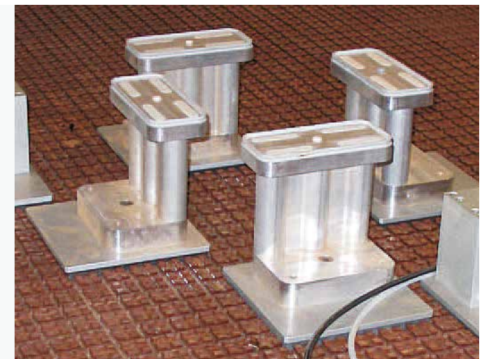
Ventose e fermi di riferimento per la massima flessibilità di bloccaggio pezzo
