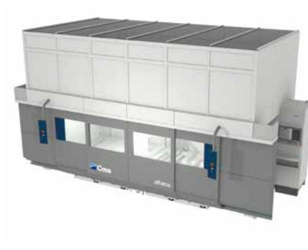
Cabina integrale per il contenimento polveri e la diminuzione della rumorosità
