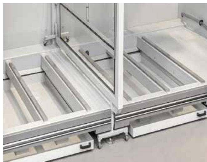
Tappeto convogliatore sotto la tavola, per evacuazione del truciolo
