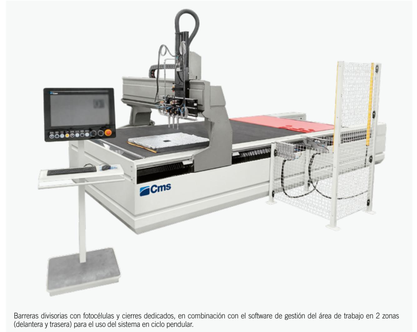
Barreras divisorias con fotocélulas y cierres dedicados, en combinación con el software de gestión del área de trabajo en 2 zonas (delantera y trasera) para el uso del sistema en ciclo pendular.
