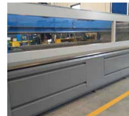
Puerta delantera y trasera con movimiento neumático para una mejor protección de la zona de corte y contención de las reverberaciones de agua y abrasivos.
