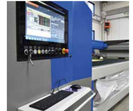
PC Panel industrial de 21,5" a bordo de la máquina con display táctil e interfaz HMI CMS Active.
