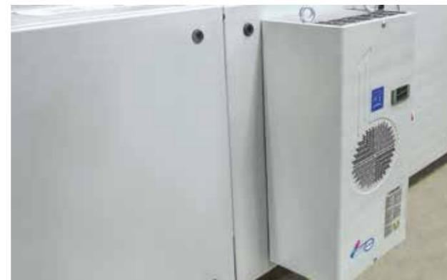
Acondicionador del armario eléctrico de la mesa de corte para temperaturas ambiente comprendidas entre 35 °C y 40 °C.
