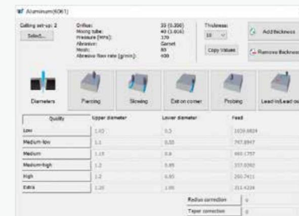
El paquete incluye también el plug-in JDE para la gestión de las tecnologías de corte almacenadas en una base de datos de materiales completa. El programa máquina se genera automáticamente en función de la selección de la calidad de corte deseada pudiendo elegir entre 5 opciones (Q1, Q2, Q3, Q4 y Q5) que determinan los ajustes de velocidad de avance y aceleración en los ángulos interiores y exteriores. El programa ISO se puede enviar a la máquina a través de la red local o mediante unidad USB.
