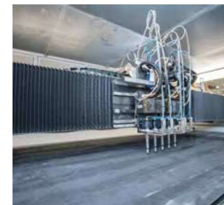
MOVIMENTAZIONE Trasmissione a pignone e cremagliera ad elevata precisione e prestazione.
