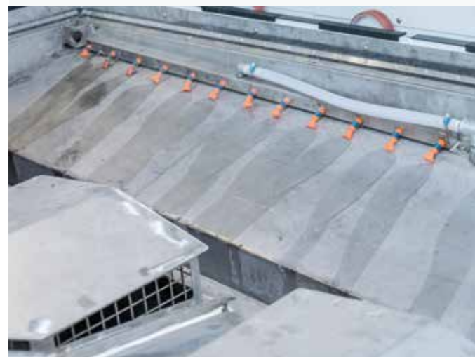
SISTEMA PULIZIA VASCA AUTOMATICO Un set di ugelli posizionati all'interno della vasca consentono di convogliare i detriti di lavorazione verso il filtro di scarico esterno.
