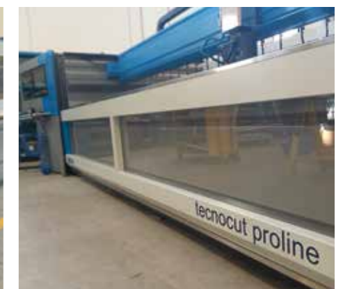
Portella frontale e posteriore con movimento pneumatico per una migliore protezione dall'area di taglio e contenimento dei riverberi di acqua e abrasivo.
