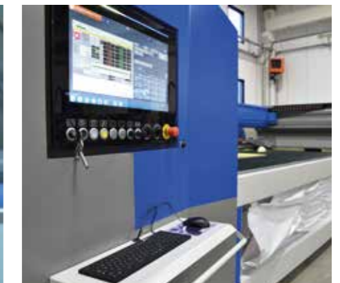
PC Panel industriale da 21,5" a bordo macchina con display touch e interfaccia HMI CMS Active.
