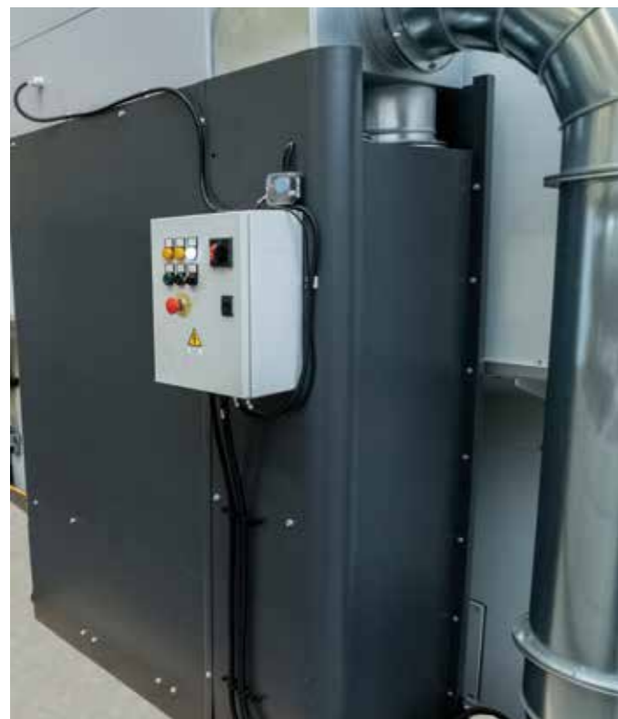
ASPIRAZIONE DEL VAPORE Sistema di aspirazione per l'evacuazione del vapore con filtro assoluto HEPA 99.997%, posizionato a lato della macchina.
