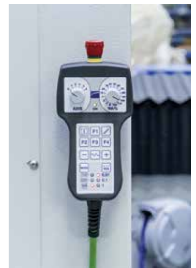
Pulsantiera remotata per controllo fino a 6 assi che consente di operare vicino al piano di taglio e di impostare multiorigini.
