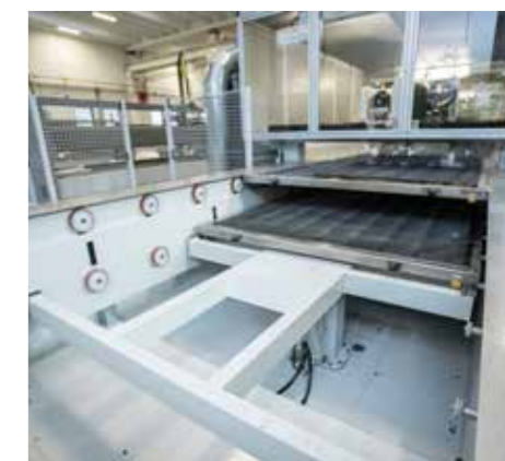
CAMBIO PALLET AUTOMATICO Zone di carico e scarico separate con movimentazione automatica dei pallets tramite servomotore.
