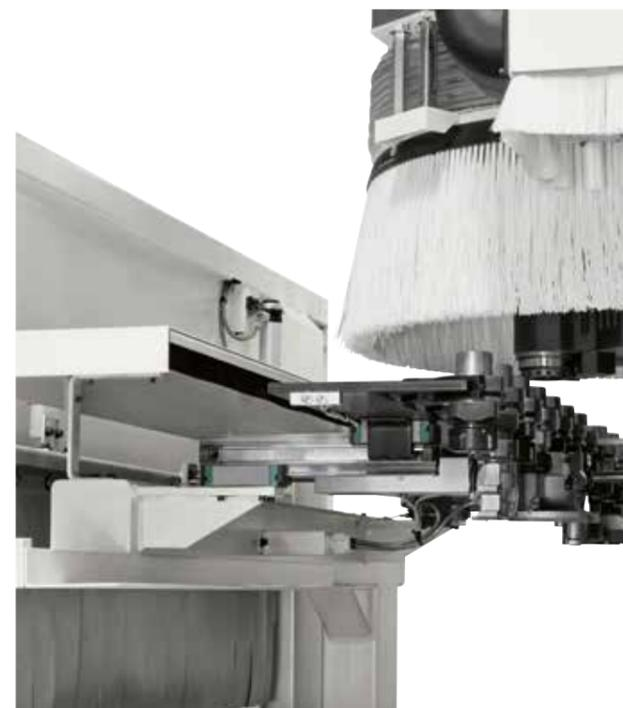
\* Para todas as versões disponíveis Armazém "pick-up" ancorada à travessa móvel. Configuração ideal para a utilização de ferramentas e cabeças de retorno angular voluminosas.
