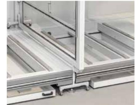
Sistema de recogida de las virutas con depósitos sobre ruedas de extracción frontal. Los depósitos, extraíbles incluso con las puertas cerradas, representan la solución más ergonómica, funcional y rápida para mantener la zona de trabajo limpia y eficiente.
