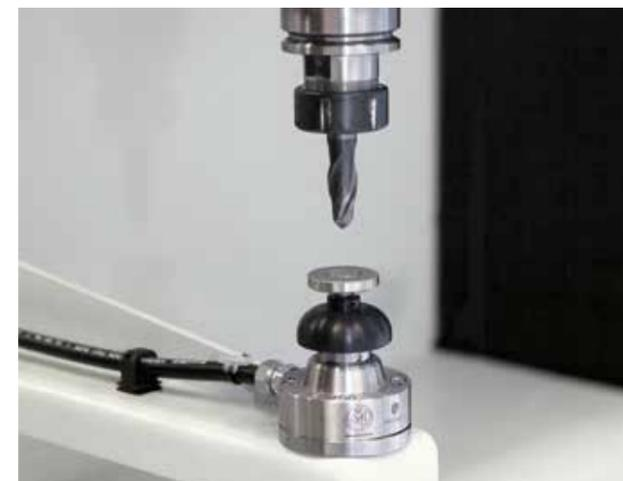
Palpador por contacto para el control y la recalificación de los ejes giratorios
