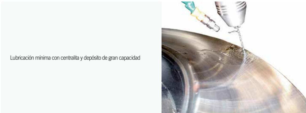
Lubricación mínima con centralita y depósito de gran capacidad
