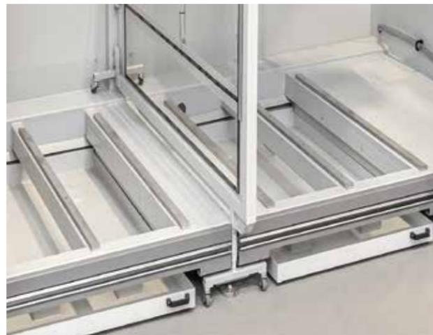
Förderband unter dem Tisch für den Abtransport der Späne
