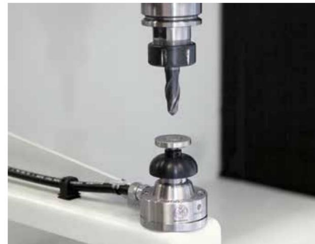
Kontakttaster für die Kontrolle und Aktualisierung der Drehachsen.
