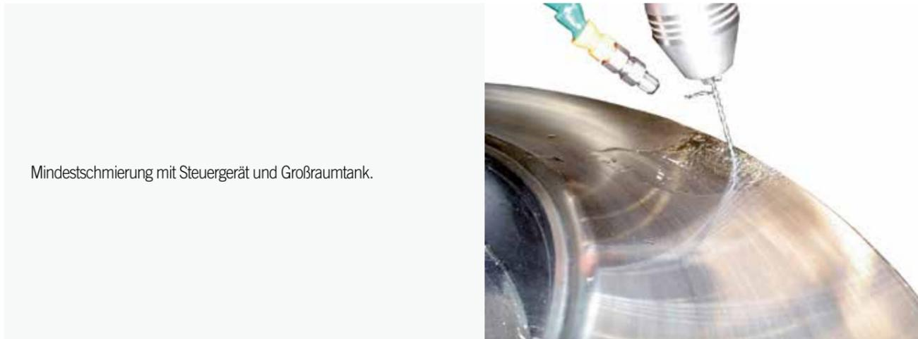
Mindestschmierung mit Steuergerät und Großraumtank.
