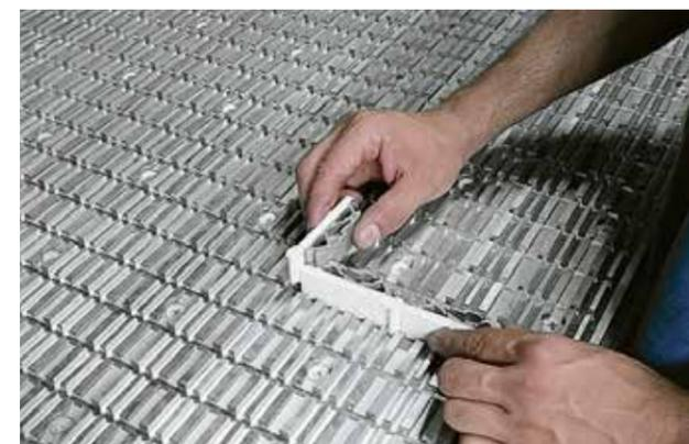
Einfache und schnelle Positionierung des Spannzubehörs wie Saugnapfe MPS und das praktische Baukastensystem MODULSET mit Oberflächenkanalstruktur.
