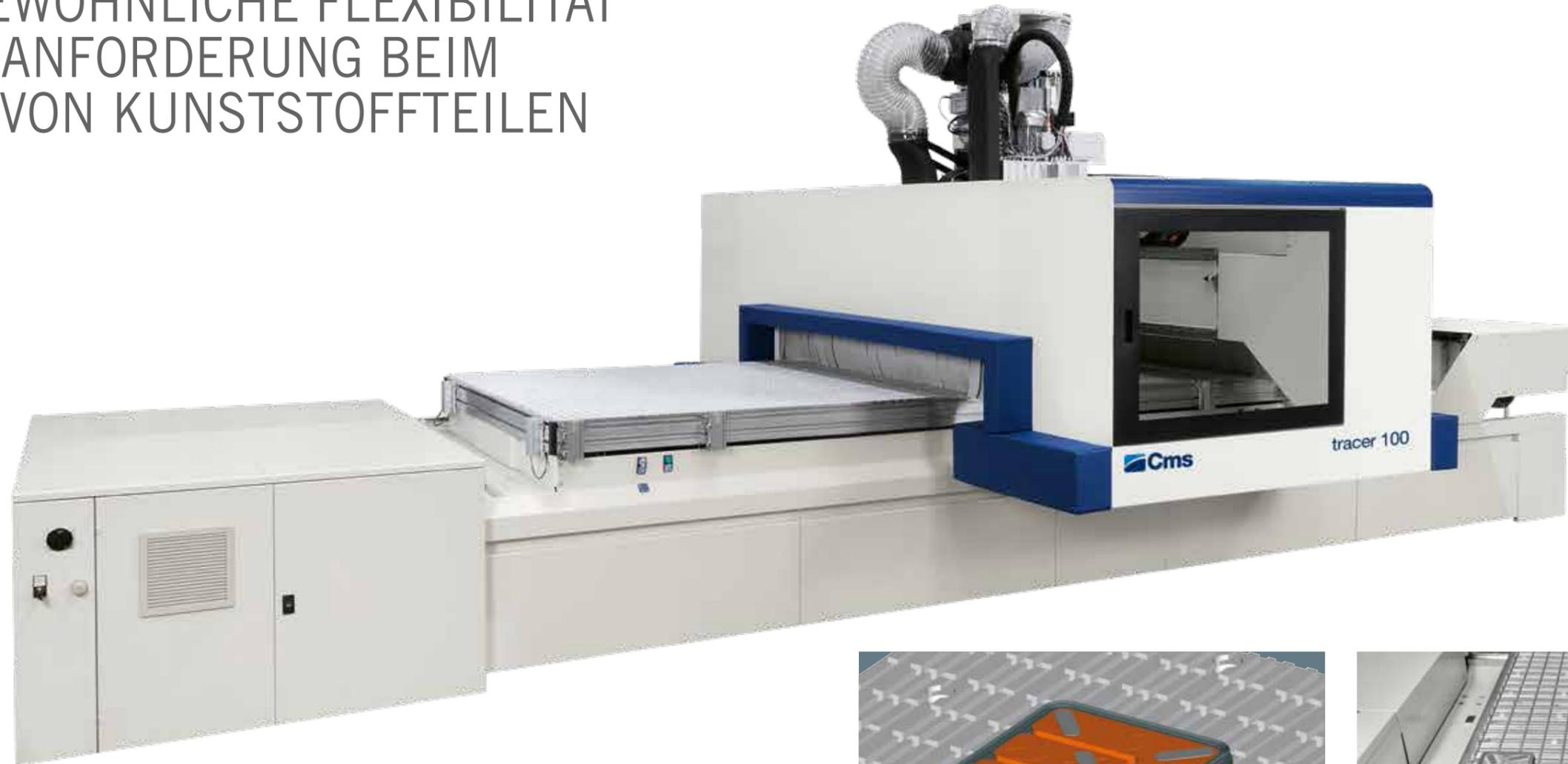
Arbeitstisch aus fließgepresstem Aluminium, extrem stabil, speziell für eine perfekte Ebenheit auch nach wiederholter Beanspruchung ausgelegt, ideal auch für Nestingprozesse.
