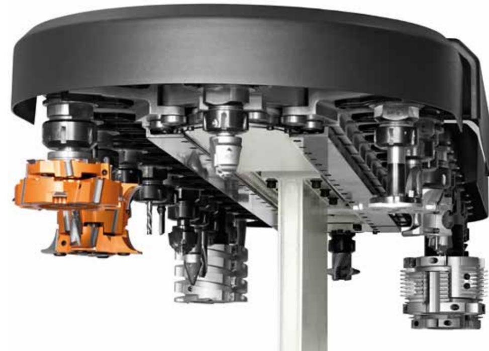
Großes Werkzeugsortiment, das dem Bediener dank der hinteren Magazine mit bis zu 32 Positionen immer zur Verfügung steht.
