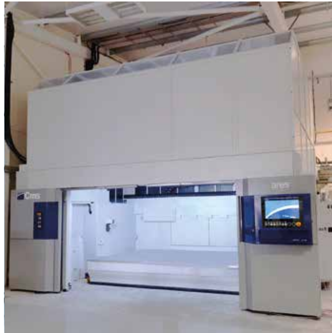
Integrierte Schallschutzkabine zur Staubeindämmung, komplett mit Innenbeleuchtung
