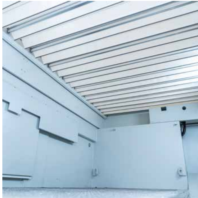
Balgdeckel, der das Entweichen von Dämpfen, Staub und Spänen aus dem Arbeitsbereich verhindert
