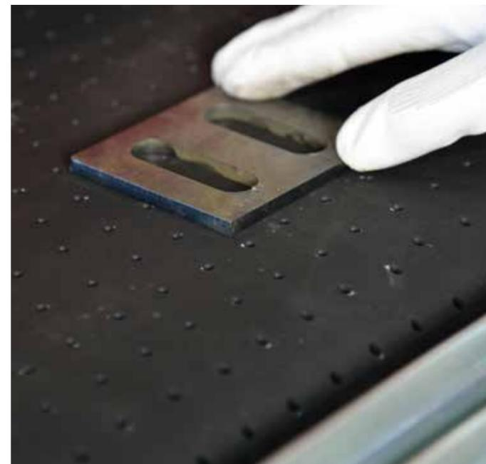
Le convoyeur en caoutchouc naturel au profil lisse et à l'adhérence élevée, associée au dispositif de dépression du plan de travail, permet l'usinage de pièces petites et fines.
