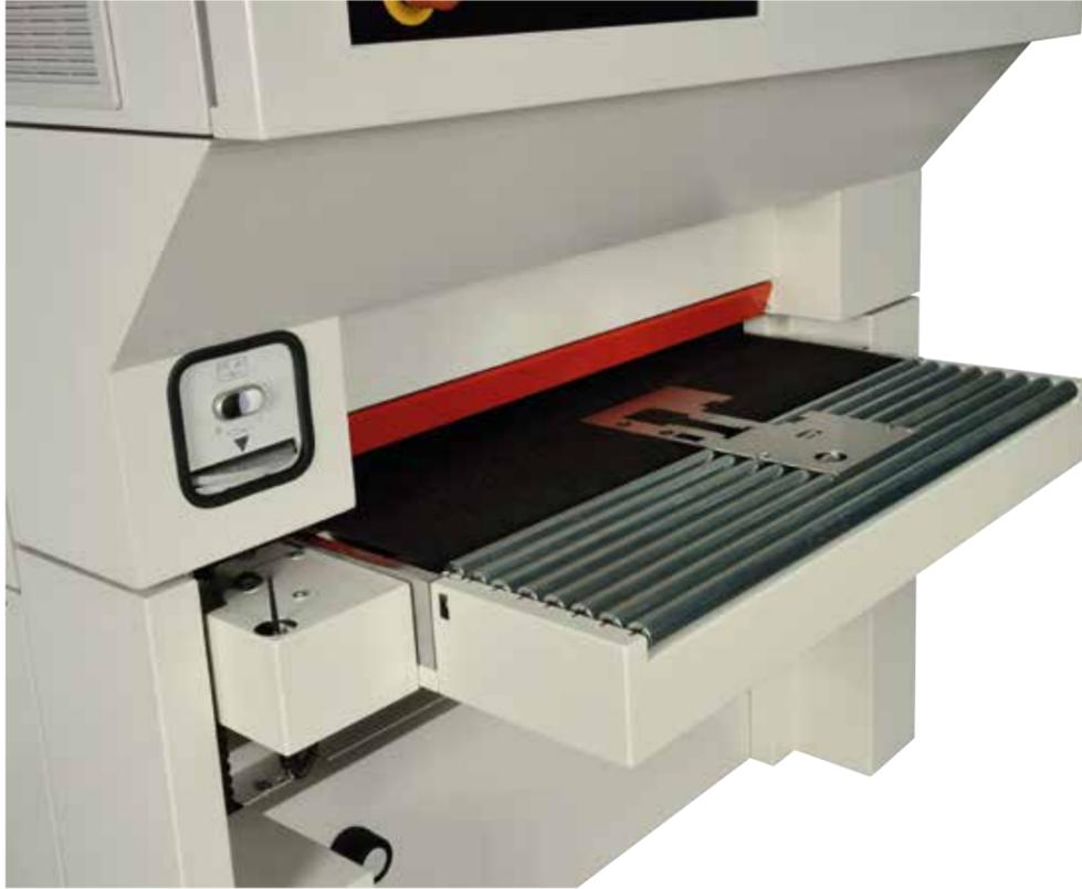
Le convoyeur à rouleaux à l'entrée et à la sortie de la machine, composé de rouleaux libres obtenus à partir de barres d'acier étirées et accouplées entre elles, permet de résister à la corrosion de l'huile et aux lourdes charges de travail.
