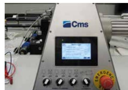
Control electrónico de la presión de corte
