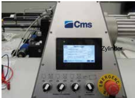
Elektronische Kontrolle des Schneidedrucks mittels Software
