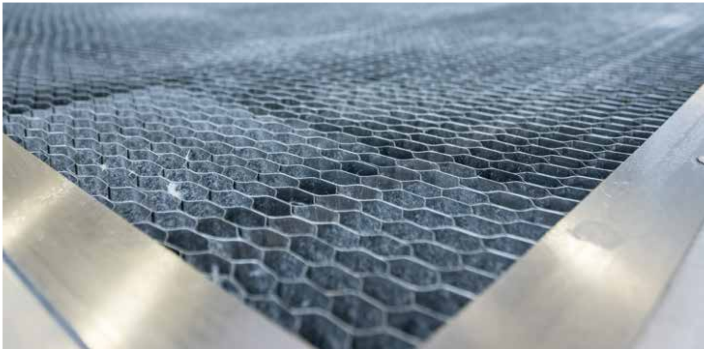
放置台 专用于塑料切割的不锈钢蜂窝格栅。 选配：用于切割卷材的不锈钢丝网。
