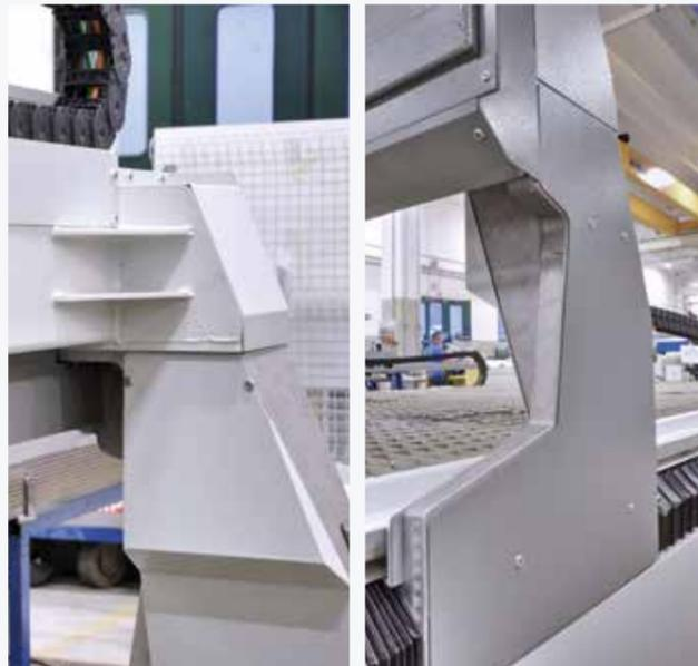
“Fundiciones de aluminio para los montantes del travesaño de acero electrosoldado diseñado con nervios y refuerzos para eliminar las vibraciones durante el corte y garantizar un elevado rendimiento.”
