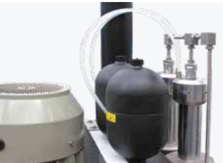
Acumulador de azoto para a gestão do circuito de retorno dos cilindros hidráulicos.
