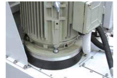
Pompa idraulica ad ingranaggi
