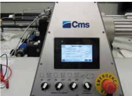
Contrôle électronique de la pression de coupe
