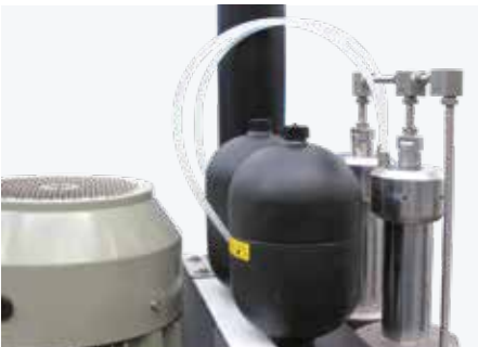
Accumulateur d'azote pour la gestion du circuit de retour des vérins hydrauliques
