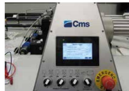
Elektronische Steuerung des Schneiddrucks
