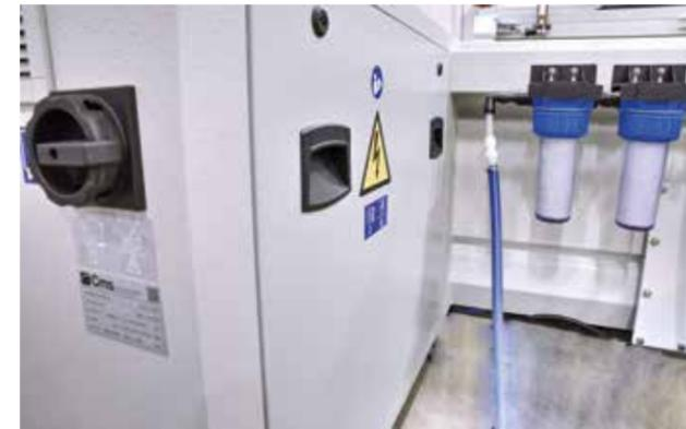
Um den Platzbedarf zu reduzieren, wurde der Schaltschrank im Maschinengestell integriert.
