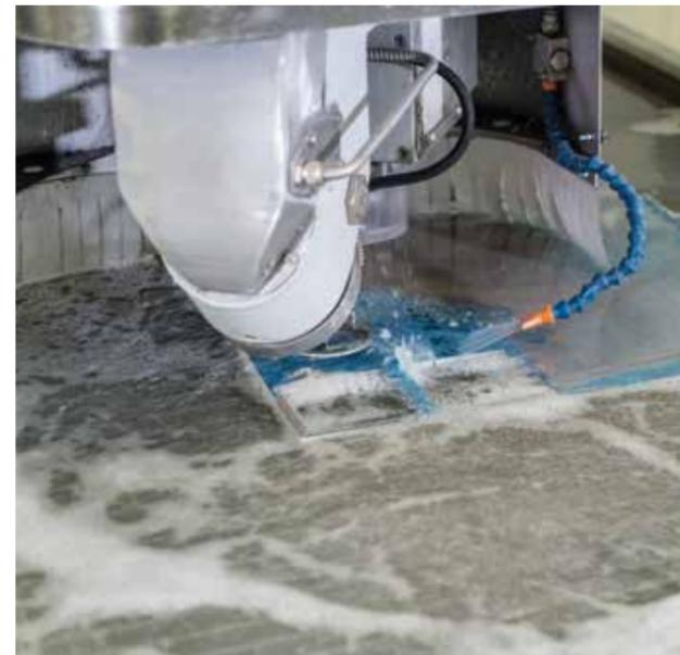
Sistema de lavado de la zona de trabajo para reducir la posibilidad de rayar la superficie de la pieza, permitiendo además que el palpador detecte correctamente el espesor del material. (opcional)
