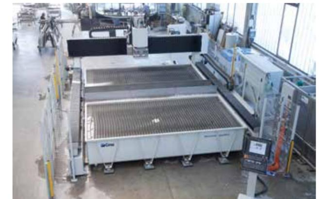
Versión con doble depósito para mecanizado en pendular (opcional)
