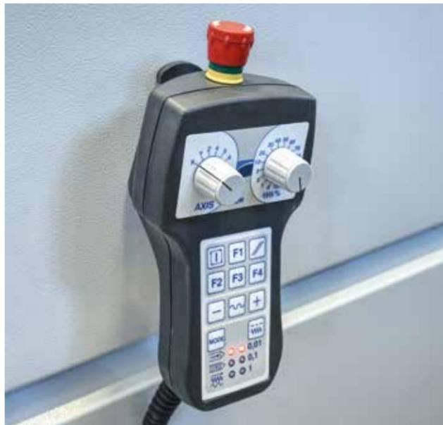
Botonera por remoto para controlar hasta 6 ejes que permite operar cerca del plano de corte y configurar multiorígenes. (opcional)
