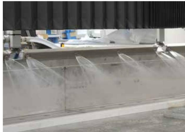
Barra di lavaggio lastra con pompa di ricircolo per la rimozione in automatico dei residui di abrasivo depositati sulla lastra durante il taglio. E' stato previsto un ciclo di lavaggio dopo la lavorazione in modo che l'abrasivo non interferisca con le operazioni di movimentazione e bloccaggio lastra.
