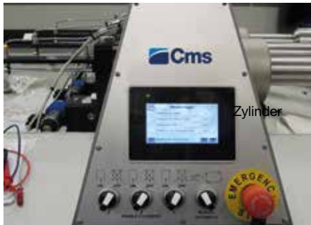
Elektronische Kontrolle des Schneidedrucks mittels Software
