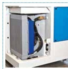
Echangeur de chaleur air/huile Luft-/Ölaustauscher
