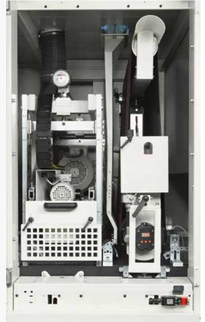
Il nuovo sistema di bloccaggio dei gruppi al basamento ed il visualizzatore digitale della quota di lavoro con risoluzione centesimale rendono il settaggio della macchina estremamente rapido e preciso.
