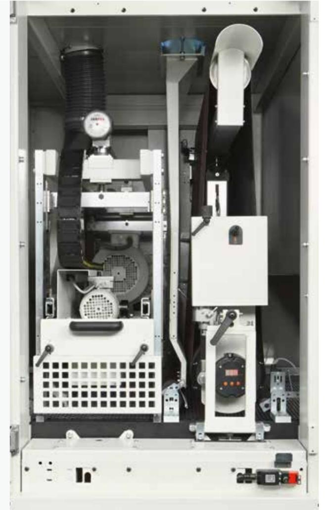
Das neue System für die Verriegelung der Aggregate am Untergestell und die digitale Anzeige des Arbeitsmaßes mit Auflösung in Hundertsteln sorgen für eine extrem schnelle und präzise Einstellung der Maschine.
