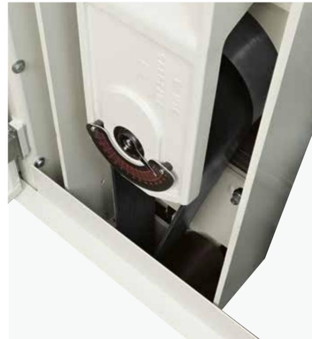
Die Übertragung der Motorleistung auf die Kontaktwalze erfolgt über einen „Poly-V“-Riemen, um den Wirkungsgrad zu maximieren und den Geräuschpegel auf ein Minimum zu reduzieren. Darüber hinaus ist ein automatisches Riemenspannsystem vorhanden, um jederzeit ideale Zugbedingungen zu gewährleisten. Dieses ermöglicht gemeinsam mit der Kontaktwalze mit vergrößertem Exzenterstift die Ausrüstung des Aggregats auch mit Bändern mit hoher Stärke insbesondere für die Oberflächenbearbeitung.
