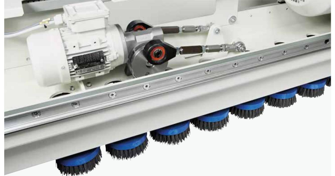
Der seitliche Auszug des Aggregats für den Austausch der Bürsten und für planmäßige Wartungsarbeiten erfolgt mit einem Teleskopsystem auf kugelgelagerten Führungen und bietet langfristig maximale Stabilität und Zuverlässigkeit. Um auch beim Entgraten großformatiger Werkstücke optimale Ergebnisse zu erzielen, erfolgt die Schwingbewegung des Aggregats über einen Quermotor und ein Getriebe mit doppelter Pleuelstange.
