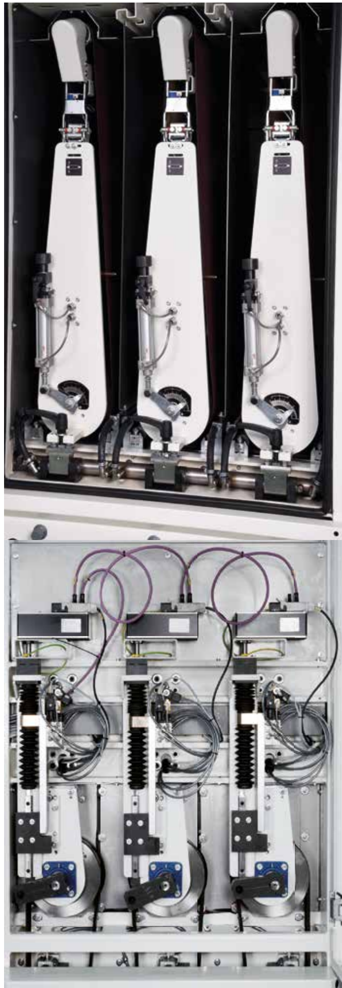
砂轮组 通过无刷电机电动调节加工装置，可保证加工装置快速定位，精度不随时间变化。通过触屏控制面板可以显示当前砂带的厚度，包括磨损后或新砂带厚度，以始终在待加工材料的表面上保持恒定的预载荷。
