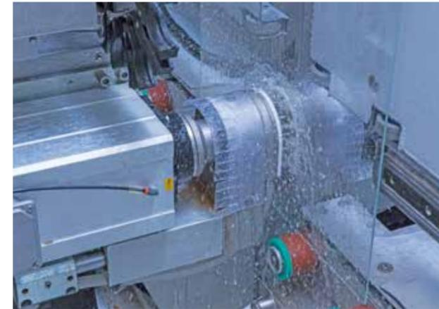
A máquina está equipada com dois prensadores opostos que têm a finalidade de estabilizar a peça durante os processamentos.
