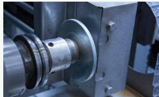
É possível utilizar ferramentas com terminal 1/2" gás com um comprimento de 75 ou 95 mm. Fresadoras combinadas, escareadoras cónicas e mós para polir processamentos de fresagem.
