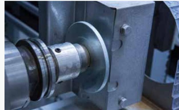
È possibile utilizzare utensili con attacco 1/2" gas con una lunghezza di 75 o 95 mm.
