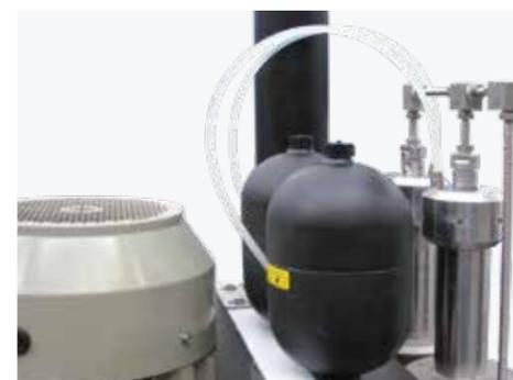
Acumulador de nitrógeno para la gestión del circuito de retorno de los cilindros hidráulicos
