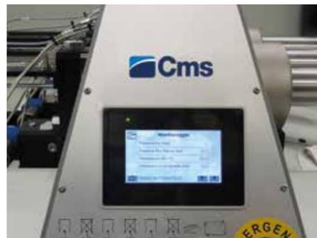
Control electrónico de la presión de corte
