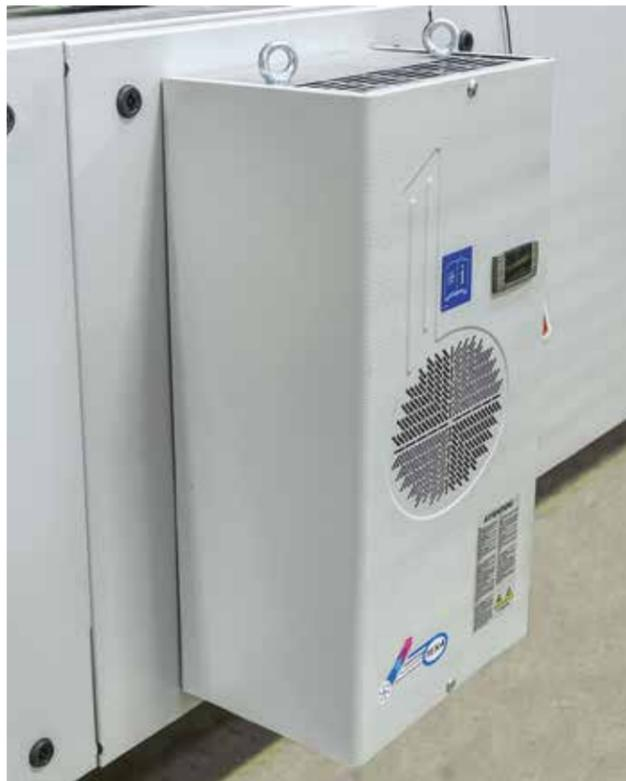
Acondicionador del armario eléctrico de la mesa de corte para una temperatura ambiente comprendida entre los 35 °C y los 40 °C.
