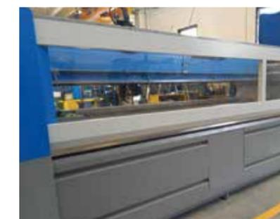
Porta frontal e traseira com movimento pneumático para melhor protecção da área de corte e contenção das reverberações de água e abrasivos
