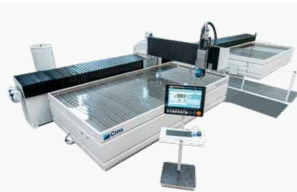
Versão com tanque duplo para processamento pendular.
