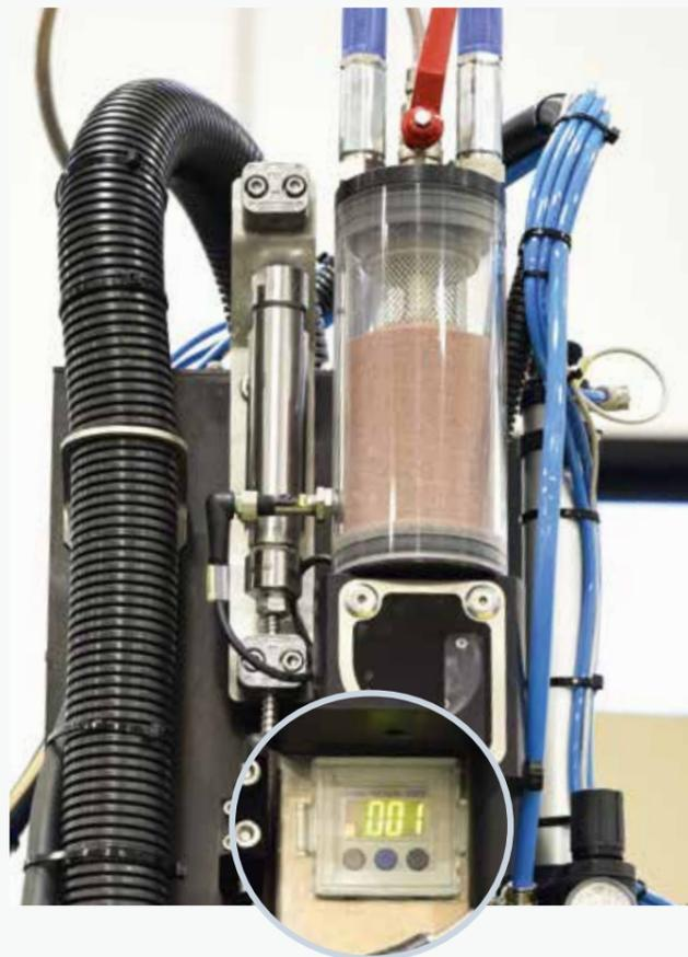
Tremonha eletrônica para o controlo automático do caudal de abrasivo. Se o fluxo de abrasivo parar por qualquer motivo, o sistema irá parar automaticamente para evitar danos à cabeça de corte ou danificar o material. Além disso, um sensor de vácuo conectado à câmara de mistura deteta constantemente variações na adução de abrasivo ao jato de água, fornecendo informações em tempo real sobre o estado de desgaste da cabeça de corte.
