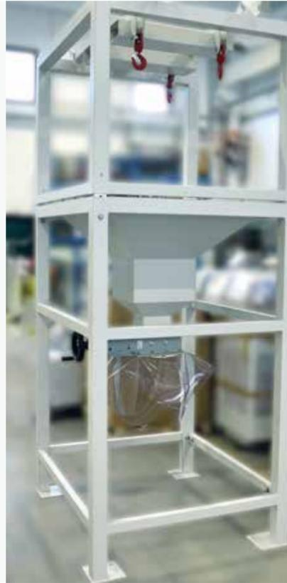
Propulsor abrasivo com uma capacidade de 330 kg para a alimentação do abrasivo equipado com dois reservatórios: um com uma capacidade de 330 kg e outro, pressurizado, para alimentar a cabeça de corte (doseador eletrônico).
