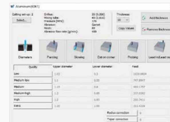
Incluído no pacote é fornecido o plug-in JDE para gerir as tecnologias de corte armazenadas num banco de dados de materiais completo. O programa da máquina é gerado automaticamente com base na seleção da qualidade de corte desejada a partir de 5 possíveis (Q1, Q2, Q3, Q4 e Q5) que determinam as configurações da taxa de avanço e a aceleração nos ângulos internos/externos. O programa ISO pode então ser transferido para a máquina através da rede local ou através da unidade USB.
