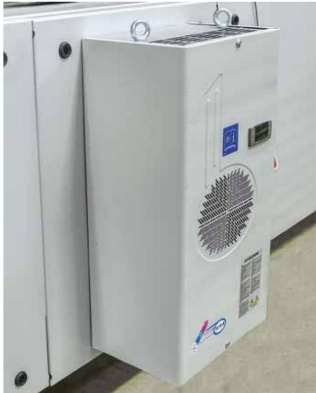
Condicionador de armário elétrico da mesa de corte para temperaturas ambiente compreendidas entre 35 °C e 40 °C.
