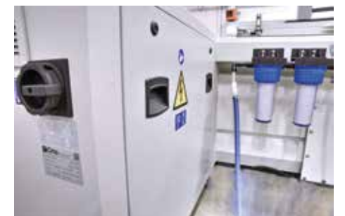
Panneau électrique intégré dans la base du réservoir pour réduire l'encombrement au sol
