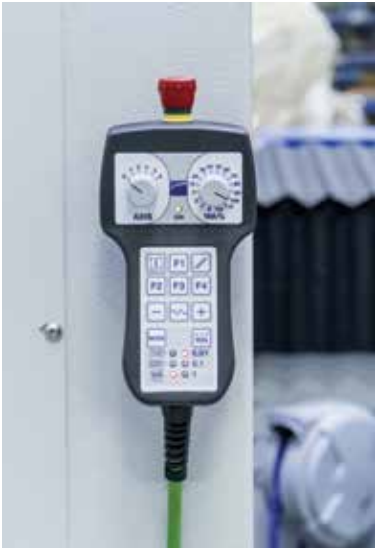
Panneau de commande à distance permettant de contrôler jusqu'à 6 axes pour travailler à proximité de la table de coupe et définir des origines multiples
