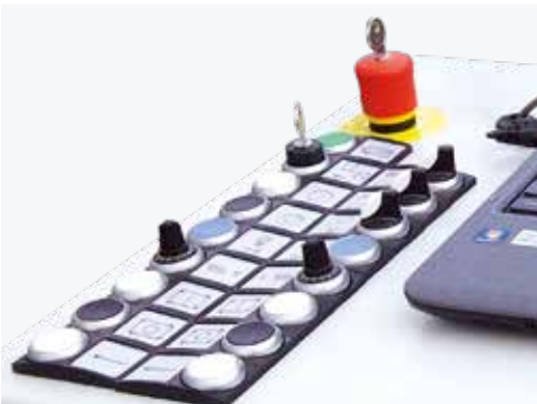
Contrôle de la pression et du fonctionnement de l'intensificateur géré directement à partir de la console
