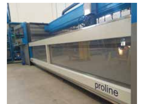
Porte avant et arrière avec mouvement pneumatique pour une meilleure protection de la zone de coupe et confinement de l'eau et des reflets abrasifs
