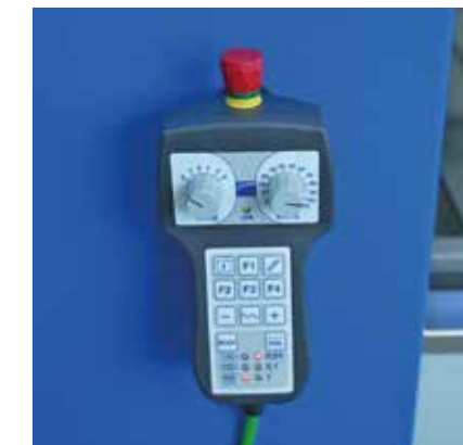
Panneau de commande à distance permettant de contrôler jusqu'à 6 axes pour travailler à proximité de la table de coupe et définir des origines multiples
