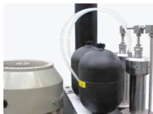
Stickstoffspeicher für die Steuerung des Rücklaufkreislaufs der Hydraulikzylinder
