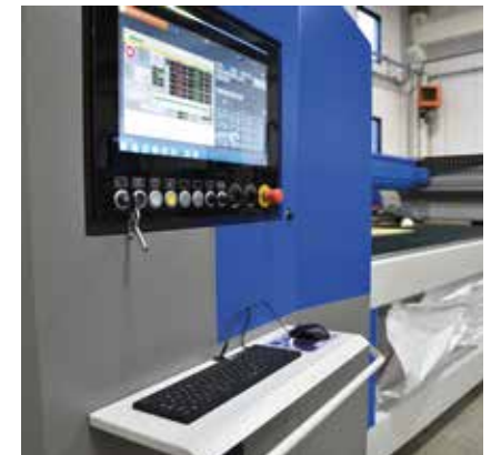
21,5"-Industrie-Panel-PC auf der Maschine mit Touch-Display und HMI-Schnittstelle CMS Active.
