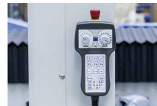
Fernbedienfeld für die Steuerung von bis zu 6 Achsen, für die Arbeit in der Nähe des Schneidtisches und die Einstellung von Mehrfachursprungspunkten (optional)
