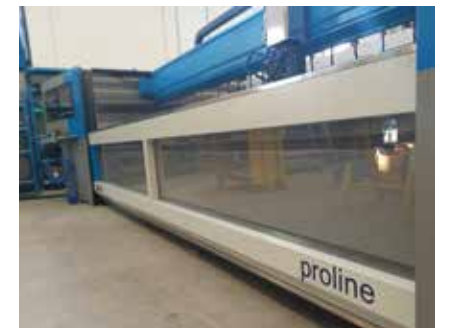
Vordere und hintere Klappe mit pneumatischer Bewegung für den besseren Schutz des Schneidebereiches und die Eindämmung von Wasser- und Schleifmittelspritzern.
