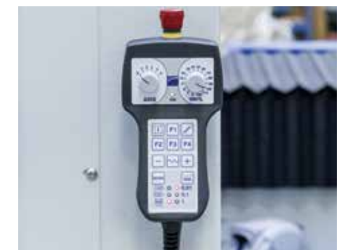
Fernbedienfeld für die Steuerung von bis zu 6 Achsen, für die Arbeit in der Nähe des Schneidtisches und die Einstellung von Mehrfachsprungpunkten (optional)
