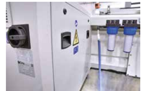
Um den Platzbedarf zu reduzieren, wurde die Schalttafel im Untergestell des Behälters integriert
