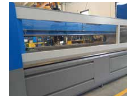
Vordere und hintere Klappe mit pneumatischer Bewegung für den besseren Schutz des Schneidebereiches und die Eindämmung von Wasser- und Schleifmittelspritzern.
