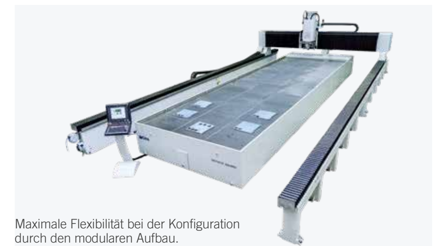
Fernbedienfeld für die Steuerung von bis zu 6 Achsen, für die Arbeit in der Nähe des Schneidtisches und die Einstellung von Mehrfachsprungpunkten.
