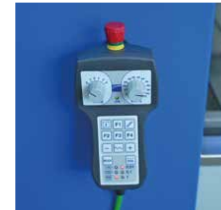
Fernbedienfeld für die Steuerung von bis zu 6 Achsen, für die Arbeit in der Nähe des Schneidbereiches und die Einstellung von ehrschnittpunkten
