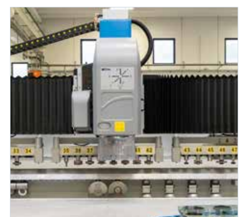
Cargador de herramientas debajo del travesaño con hasta 24 posiciones de los conos.
