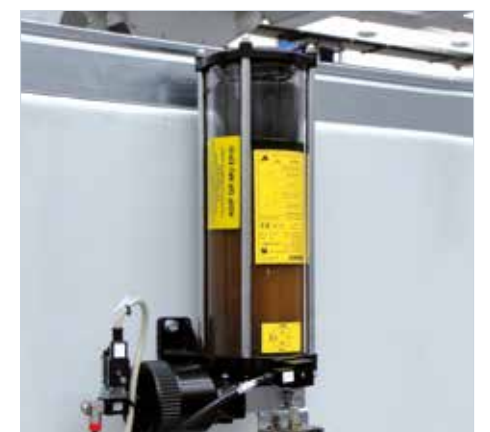
Sistema de lubricación automático.
