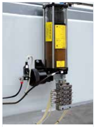
Sistema de lubricación automático.
