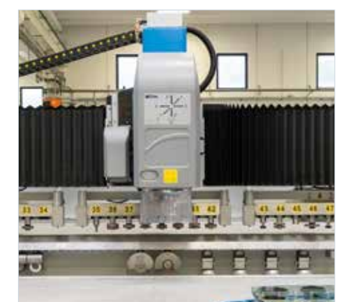
Porta-utensílios sob viga até 24 posições de cones
