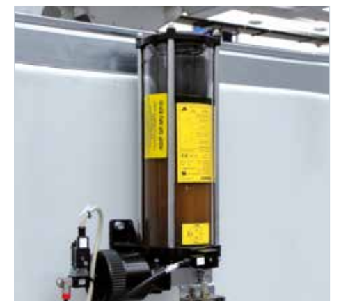
Sistema di lubrificazione automatica
