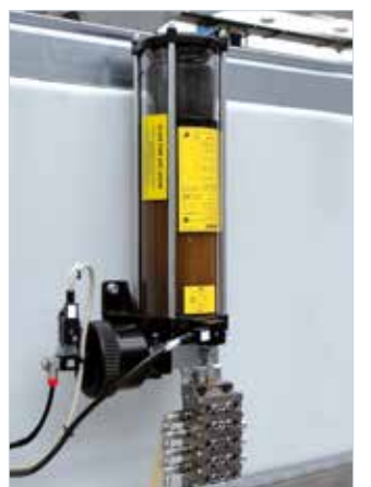
Sistema di lubrificazione automatica
