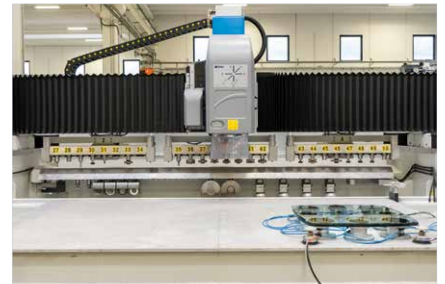
Magasins installés sous la traverse jusqu'à 24 outils.
