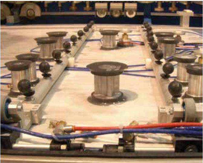
BARRES PNEUMATIQUES POUR L'AIDE AU CHARGEMENT DES PLAQUES DE VERRE Grâce à ces barres, il est possible de charger facilement les plaques de verre de grandes dimensions, même sans outils de soulèvement automatique. Dès que les plaques sont positionnées, les barres disparaissent sous la surface des ventouses.
