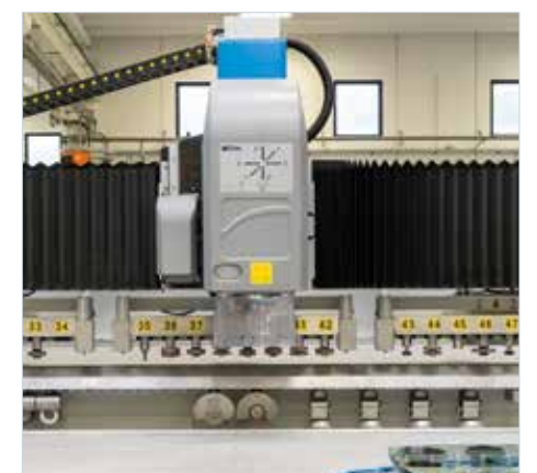
Magasins installés sous la traverse jusqu'à 24 outils.
