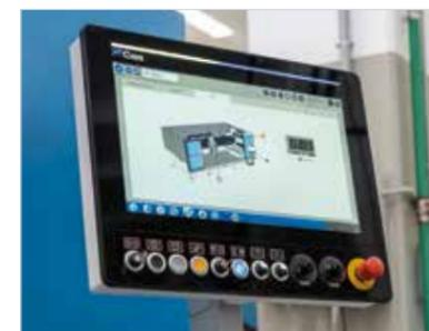
Consolle integrata alla macchina, lo schermo da 21.5" con funzione touch permette di sfruttare appieno la nuova interfaccia operatore. L'operatore viene costantemente guidato nelle operazioni più comuni per il funzionamento della macchina.
