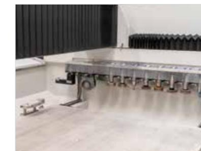
Magazzini utensili sono posizionati a lato per una migliore accessibilità e per permettere all'operatore di avere migliore visibilità degli utensili presenti a magazzino.
