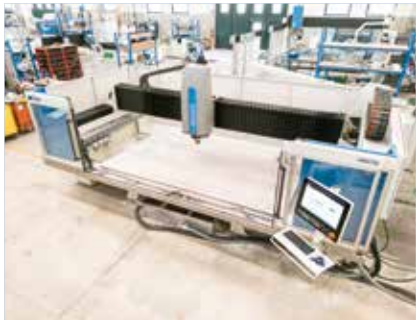
由于采用可伸缩门的设计，即使门打开，机器的占地面积也不会改变。
