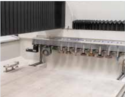
刀库位于侧面，以便于操作，并允许操作员更好地了解仓库中的工具。
