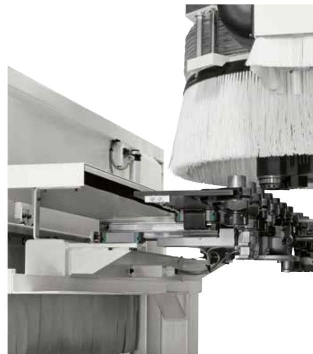
\* Per tutte le versioni disponibile Magazzino "Pick-up" ancorato alla traversa mobile. Allestimento ideale per l'utilizzo di utensili e testine a rinvio angolare ingombranti.
