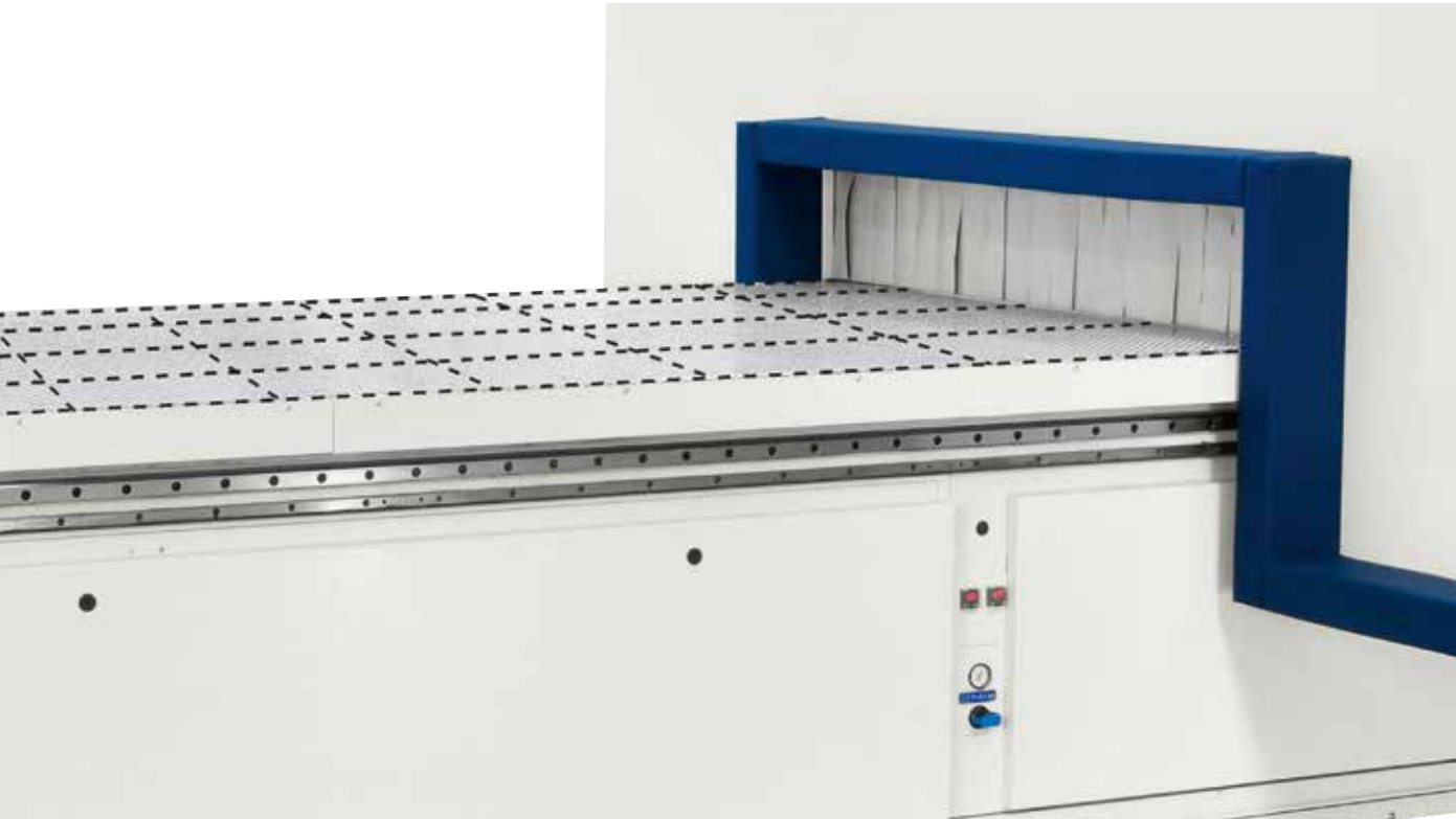
Tenue maximale des pièces uniquement là où cela est nécessaire : de 2 à 30 zones de vide en fonction des dimensions du plan de travail
