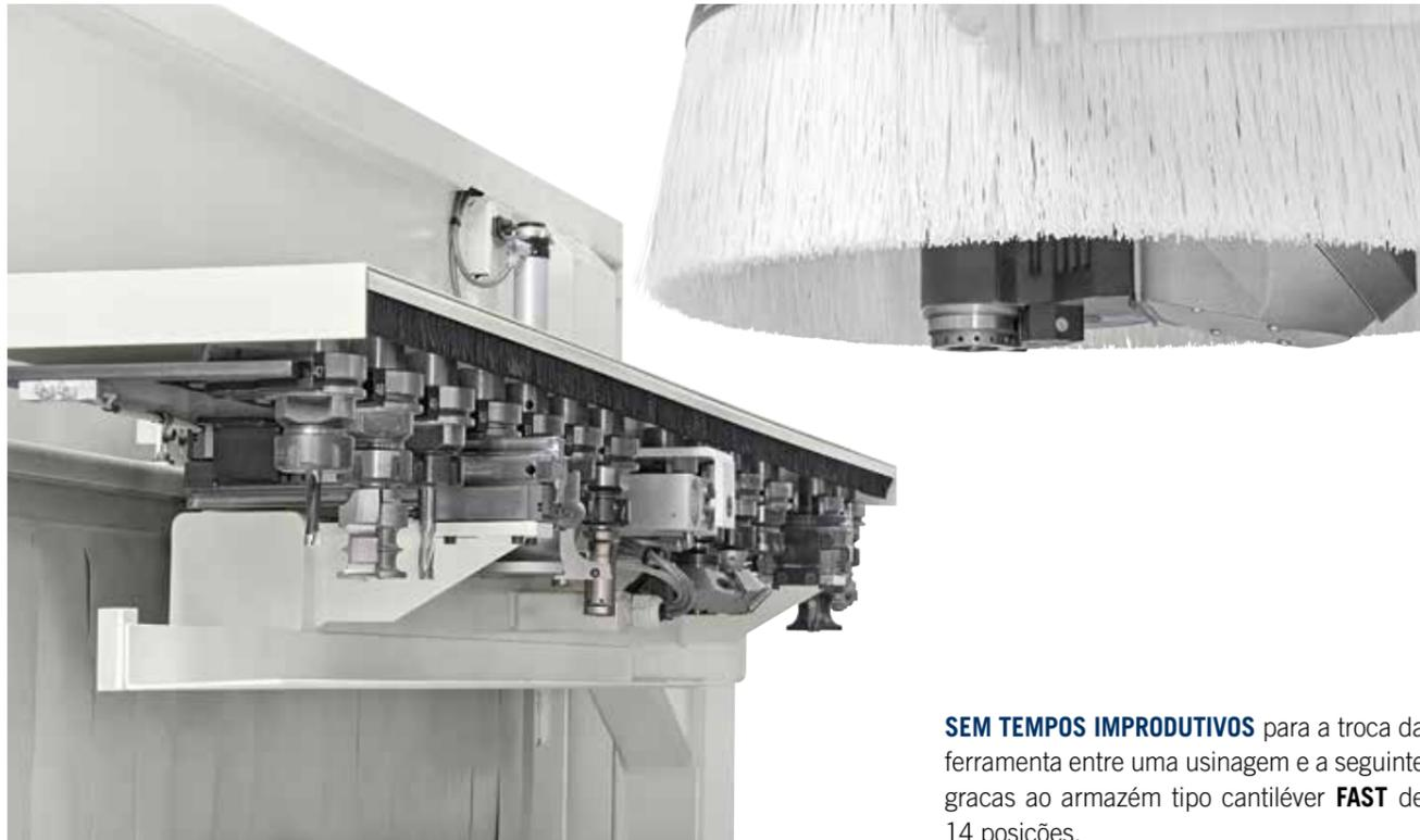
**SEM TEMPOS IMPRODUTIVOS** para a troca da ferramenta entre uma usinagem e a seguinte graças ao armazém tipo cantiléver **FAST** de 14 posições.
