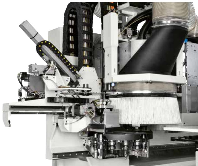
O armazém de troca das ferramentas a bordo **"RÁPIDO"** de 12 ou 16 posições, posicionado ao lado do electro mandril, permite a substituição das ferramentas em "tempo mascarado". Também disponível com prendador da lâmina, para além das outras ferramentas.
