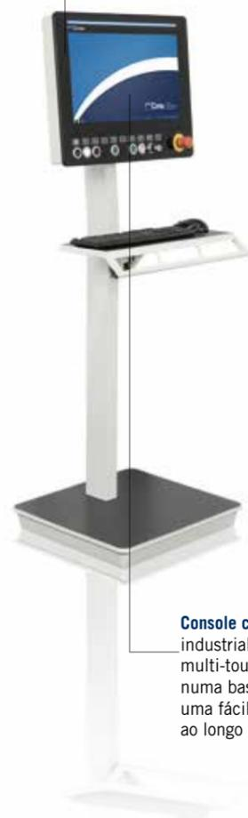
Console com PC integrado, PC industrial com ecrã 21,5”, Full HD, multi-touch a cores, posicionado numa base de apoio com rodas para uma fácil movimentação da console ao longo do perímetro da máquina.
