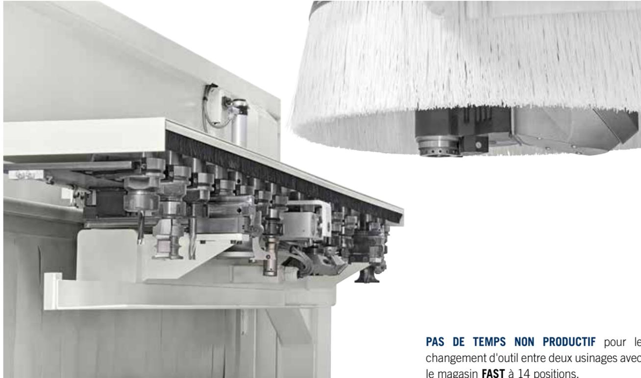
**PAS DE TEMPS NON PRODUCTIF** pour le changement d'outil entre deux usinages avec le magasin **FAST** à 14 positions.
