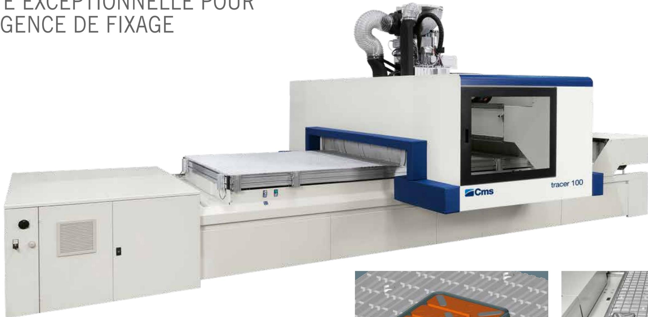
Plan de travail en aluminium extrudé, extrêmement rigide, spécialement conçu pour maintenir une parfaite planéité dans le temps, même suite à des sollicitations répétées, également idéal pour les processus d'usinage en imbrication (nesting).
