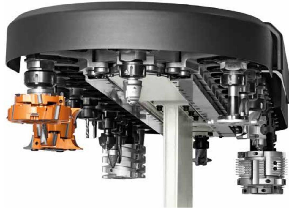
Un grand parc d'outils toujours à la disposition de l'opérateur grâce aux magasins arrière jusqu'à 32 positions.
