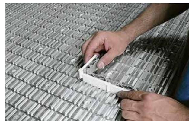
Positionnement simple et rapide des accessoires de blocage tels que les ventouses MPS et le pratique système modulaire MODULSET avec sa structure à canalisations de surface.
